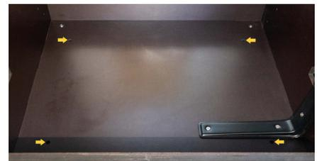
Nun können Sie den Paketkasten (vorher waagrecht ausgerichtet s. Punkt 3.1) auf dem Betonsockel festschrauben. Verwenden Sie hierfür die mitgelieferten 120 mm Schrauben und einen Torx TX40-Bit.
